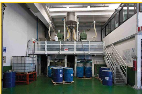
Il mastice viene applicato liquido sulle capsule di sicurezza e durante il processo di produzione viene essiccato in forni orizzontali a temperatura di circa 210°C. La sua funzione è quella di garantire la tenuta della capsula sul vaso di vetro quando il prodotto è sottoposto ai trattamenti termici (pastorizzazione, sterilizzazione, ecc.) e il sottovuoto nel tempo.
